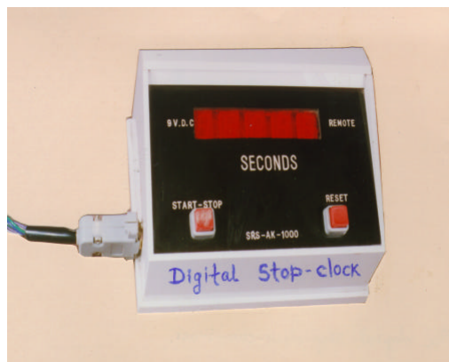
Fig. 5.1.1.2 (d) The digital stopclock cum timer
